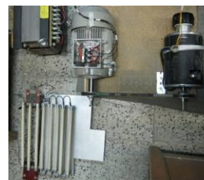
شکل 19- موتور 3 فاز همراه با ژنراتور DC و بار
